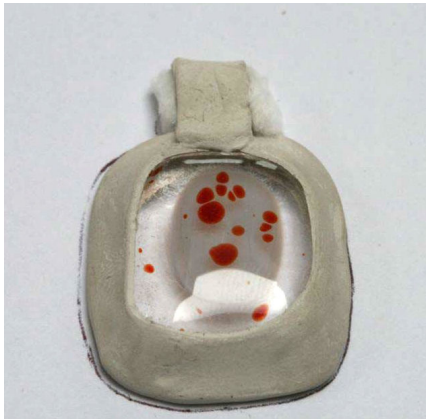
Ein exakt gebranntes Stück Glas mit ungebranntem Ton umwickelt
